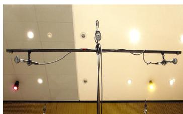
**3 micros Hypo-cardioides ou Omni** : les 2 micros **L** et **R** sur une grande barre de 1,80 m et le micro central **C** sur une perchette. On peut aussi placer des adaptateurs coulissants dans un rail d'une tringle à rideau de même longueur !!
