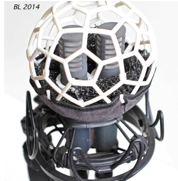
Bonnette Cinela Léonard modifiée... Suspension Rycote / Schoeps modifiée...
