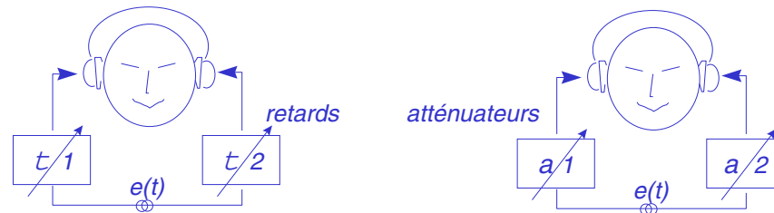
Figure : dispositif expérimental pour mesurer l'influence des ITDs et des IIDs sur la latéralisation
