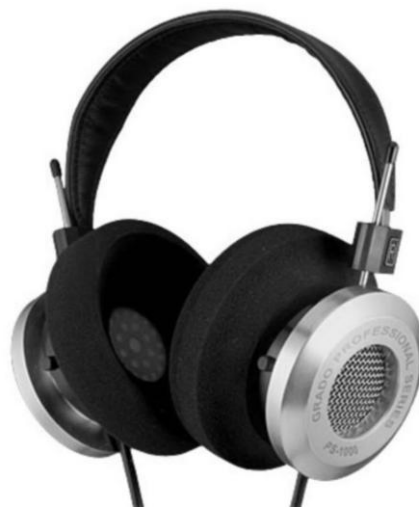
Fig D-53 : Le Casque GRADO GS 1000 est un casque électrodynamique ouvert
