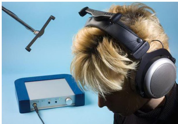
Fig D-62 : Casque avec système « head tracker » : Le système Realiser 1 comprend un petit appareil placé sur le casque serre-tête et un autre petit dispositif à l'avant de la chambre, qui surveille en même temps la position de la tête de l'auditeur, tous les cinq millisecondes. Comme la tête se déplace, et peu importe la rapidité avec laquelle il se déplace, le Realiser recalcule tous les facteurs HRTF, de façon transparente et en temps réel, le maintien d'une localisation précise par rapport à l'écran.
