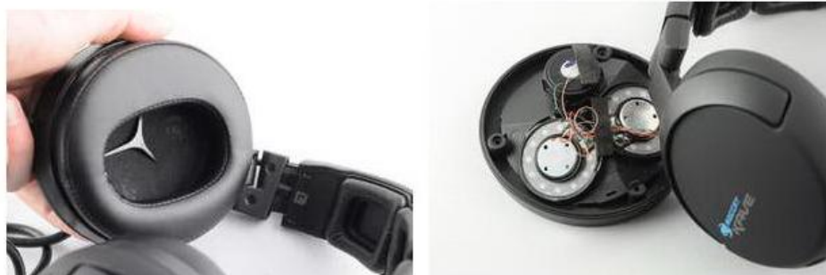
Les écouteurs imposants du Kave et les transducteurs qu'ils renferment
