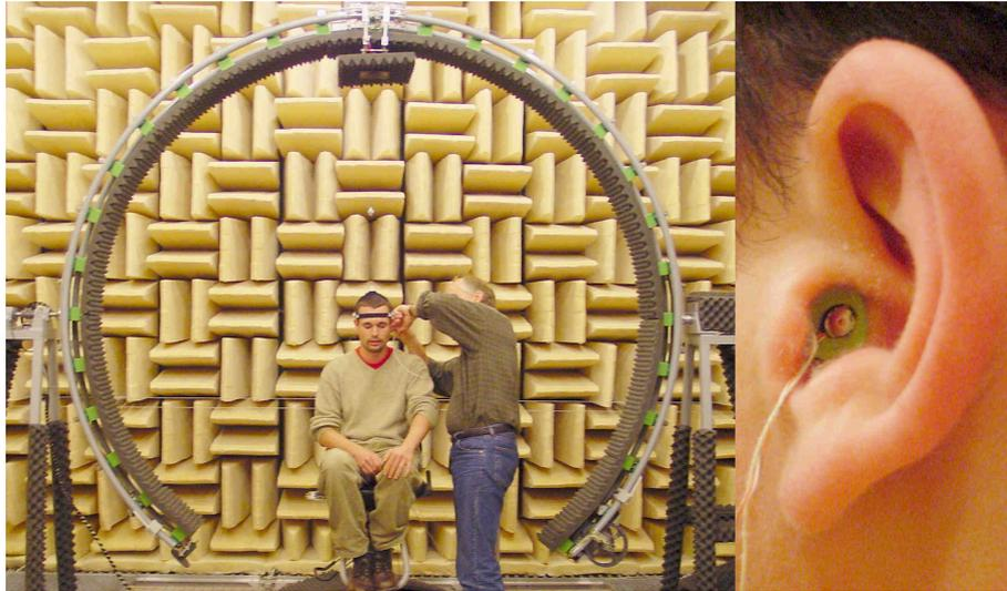
Figure 2.3 – Mesure de HRTF en chambre anéchoïque (d'après [197]).
