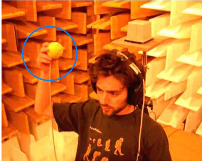
Figure 4.10 – Photographie du dispositif d'apprentissage accéléré proposé par Blum *et al.* [24]. La balle tenue en main par le sujet matérialise la source sonore, diffusée virtuellement en synthèse binaurale dynamique
