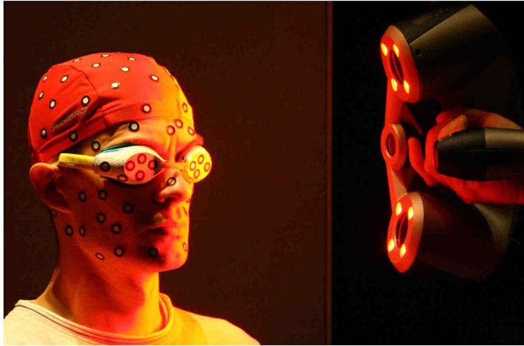
Figure 5.6 – Acquisition en 3D de la surface de la tête d'un sujet grâce à un scanner laser (*Creaform Handyscan 3D™*).
