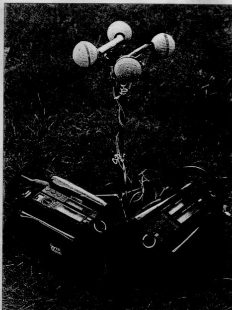
Les deux HHB PortaDAT PRD 1000 et leurs modules de synchronisation *time-code*. Les quatre micros Schoeps sont montés sur un seul support pour la prise de son 4 canaux.
